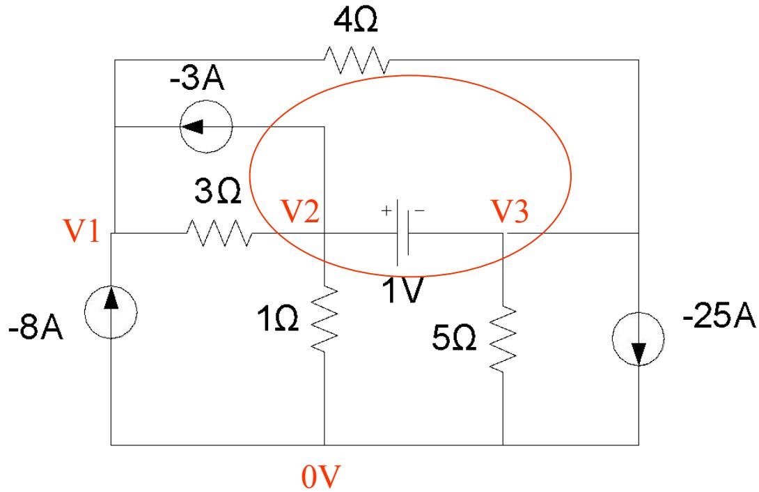
$$\frac{V_2 - V_1}{3} - 3 + \frac{V_3 - V_1}{4} - 25 + \frac{V_3 - 0}{5} + \frac{V_2 - 0}{1} = 0$$
